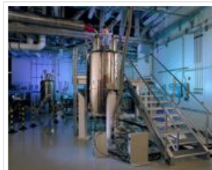
NMR instrument na Pacific Northwest National Laboratory; Vidljivi valjak je supravodljivi magnet jakosti 18.8 teslaT
