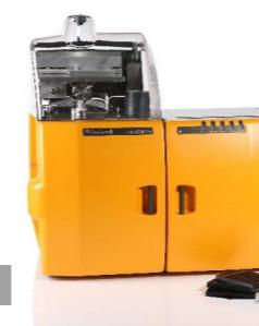
Određivanje proteina metodom po Dumasu. Ovim načinom analize ne koriste se agresivne hemikalije, trajanje analize meri se u minutima, a količina uzorka je manja od grama. Visokotehnološka rešenja čine upotrebu jednostavnom, a rezultate vrlo preciznim i pouzdanim uz izuzetan konfor i bezbednost korisnika.
