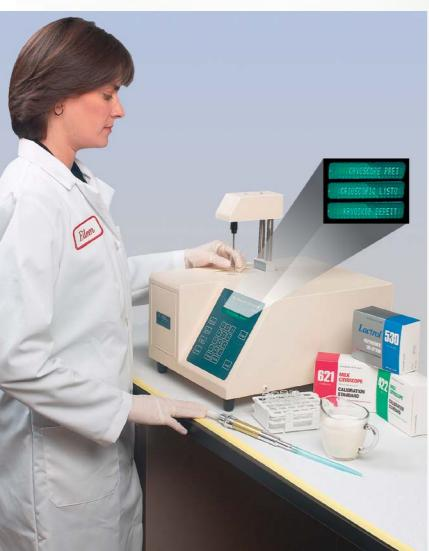
Standardni način rada uključuje  $m^{\circ}C$  ili  $m^{\circ}H$  skalu, vremensko ili traženo podešavanje moda platoa i više-jezični displej.
