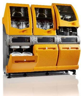
**FIBREtherm** je namenjen za analizu sadržaja celuloze i nesvarljivih vlakana ali i ADF i NDF vlakana. Jedinstven je po kapacitetu od 12 mesta koji može i ne mora biti u potpunosti iskorишćen. Jedinstvena i patentirana tehnologija FibreBag vrećica nudi vrhunske rezultate uz prijemčivu i jednostavnu upotrebu.
