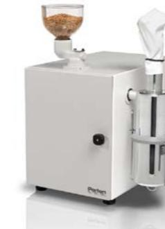
Mlin čekićar se koristi za pripremu uzorka za Broj padanja, Glutomatic sistem i NIR analize.
