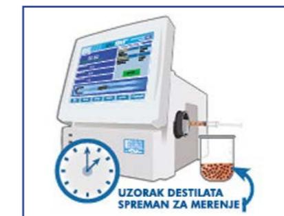
Nakon završene destilacije voda i alkohol su odvojeni od šećera i aromatičnih materija, pa se sadržaj alkohola precizno određuje denzitometrom.
