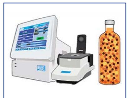
Automatski sistem AlcoTest-RI je kombinovan uređaj koji je sastavljen od denzitometra i automatskog refraktometra napredne serije J457 sa optičkim modulom sa integriranim softverom koji omogućava merenje sadržaja alkohola u zapreminskim procentima, u prisustvu drugih sastojaka, za manje od 3 minuta.
