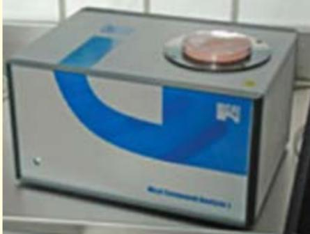
MCA je kompaktan spektrofotometar vrlo jednostavan za brzu analizu osnovnih hemijskih komponenata. Zadovoljava specijalne potrebe mesne industrije za brzu analizu **VODE, MASTI, UKUPNIH PROTEINA I PROTEINA MESA (BEFFE)** proteini koji potiču od mišića, bez kolagena i dr.proteinskih komponenata)
