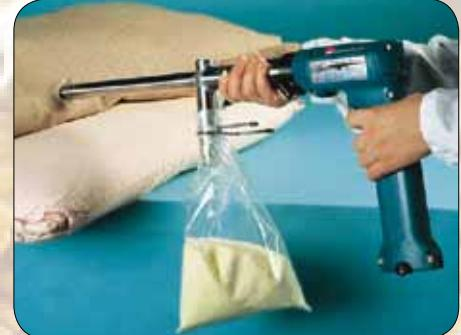
Standardne dimenzije sonde su: prečnik 38 mm, a dužina 1300 mm, a proizvode se u mnogim drugim dimenzijsama i sa različitim brojem otvora u zavisnosti od toga da li se radi o praškastom, sitnozrnastom ili krupnozrnastom materijalu.
