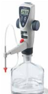
Karakteristika laganih **Transferpette®** i **Transferpette® -8 / -12** su jedinstveno hvatanje, koje omogućava pipeti da suspendira slobodno, iz ruke. Palac prirodno stoji na dugmetu za pipetiranje sa strane instrumenta, a položaj držanja ruke je opušten.
