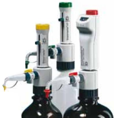
**Digitalne birete III** premošćuju jaz između teških staklenih bireta i skupih titracionih uređaja. Njegove male dimenzije i dugotrajne baterije, omogućavaju mu da se koriste u ograničenom prostoru i na mestima daleko od električnih izlaza. LCD ekran eliminiše greške očitavanja površine tečnosti u cevi. Safety-PrimeTM ventil smanjuje reagensni otpad, a bezbednosti sistem pražnjenja sistema smanjuje rizik od nehotičnog pražnjenja.
