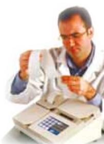
➔ Jedna od najsvremenijih metoda analize mikotoksina obuhvata ekstrakciju uzorka i prečišćavanje sa Vicam-ovim imunoafinitetnim kolonicama (SAD) koje dalje idu na tečnu hromatografiju HPLC ili se mogu koristiti za kvantitativno određivanje prisutnih mikotoksina upotreboom fluorometra.
