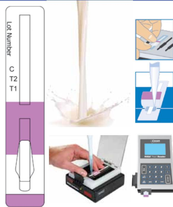
**Charm Ez** odmah identificuje boju test traćice i automatski prilagođava vreme i temperaturu inkubacije i test kalibraciju. Posle inkubacije automatski očitava rezultat na displeju aparata.
