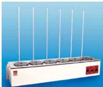
Namenjena su za kontrolisana zagrevanja i termostatiranja. Za pouzdan i efikasan rad bitan je kontroler temperature visoke preciznosti, upotreba adekvatnih stalaka i pribora, kao i korišćenje nekorozivnih tečnosti. Koriste se za zagrevanje uzoraka do željene temperature ili za termostatiranje uzoraka u posudama.
