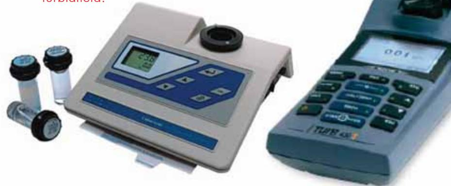
Namenjeni su merenju mutnoće uzorka vode. Mutnoća direktno zavisi od zaprljanosti vode mehaničkim česticama i taložnim supstancama. Turbidimetri mere IC ili belu svjetlost rasejanu od uzorka pod određenim uglom. Rezultate prikazuje u NTU ili FNU - formazine turbidity unit.
