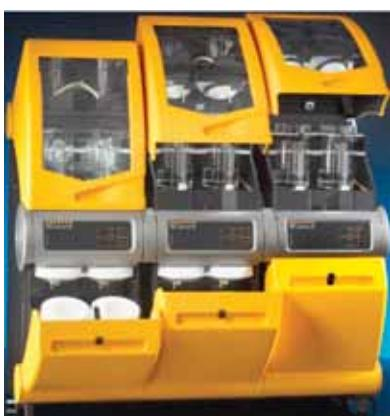
Sistemi se koriste za hidrolizu pre ekstrakcije po Soksletu. Sastavni deo sistema su elementi za zagrevanje i filtraciju. Automatski sistemi su složene konstrukcije.
