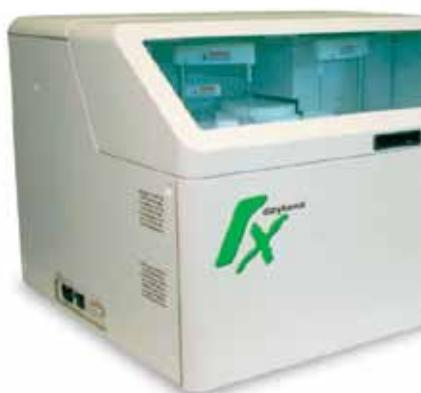
Poluautomatski i automatski biohemijski analizatori služe za određivanje osnovnih biohemijskih parametara u biološkom materijalu.
