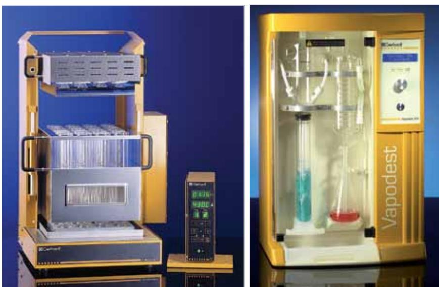
Aparati koji se koriste za određivanje sadržaja proteina u uzorku. Standaardno se sastoje od uređaja za digestiju i uređaja za destilaciju, opcionalno elementi sistema mogu biti i neutralizaciona pumpa i titrator.
