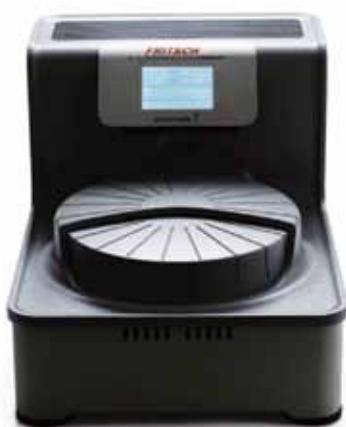
Mlinovi se upotrebljavaju za usitnjavanje materijala kao neizbežni deo pripreme uzorka u analitičkim procedurama. Mlinovi različite konstrukcije mogu se koristiti za usitnjavanje komada prečnika nekoliko centimetara na čestice veličine do veličine mikrometra. Takođe se mogu koristiti za mlevenje mekih do vrlo tvrdih materijala. Konstrukciono mogu biti mlinovi sa rotorom, mlinovi sa noževima, kuglicama, drobilice ...
