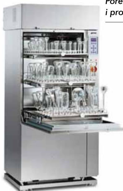
Mašina za pranje laboratorijskog posuđa su maštne specijalne konstrukcije (staklo/plastika) prilagođene pranju laboratorijskog posuđa, koriste destilovanu vodu, tečne deterdžente .... za pranje: čaša, epruveta, petri šolja, pipeta.... . U zavisnosti od vrste posuđa koje koriste mogu biti opremljene različitim tipovima nosača posuđa. Pored laboratorijskog programa postoji i program za medicinske instrumente.
