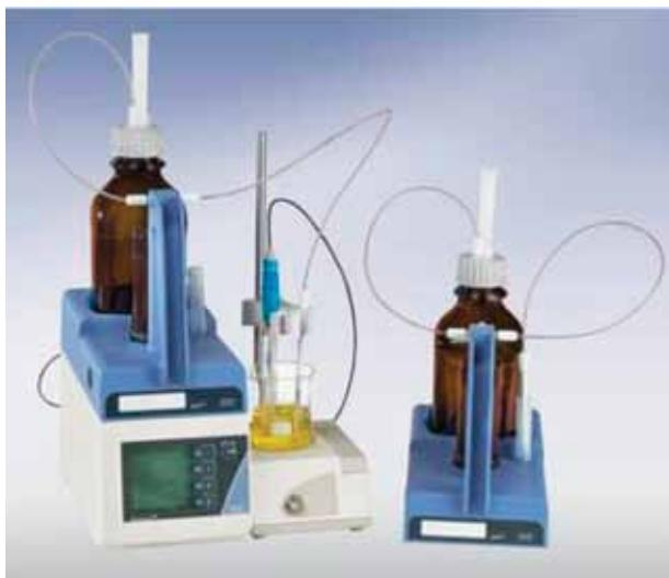
Titratori su posebna vrsta elektrohemijskih aparata, prate promene u rastvoru nastale usled dodavanja titracionog sredstva. Pored elektrohemiskog mernog uređaja poseduju i uređaj za precizno doziranje tečnosti.
