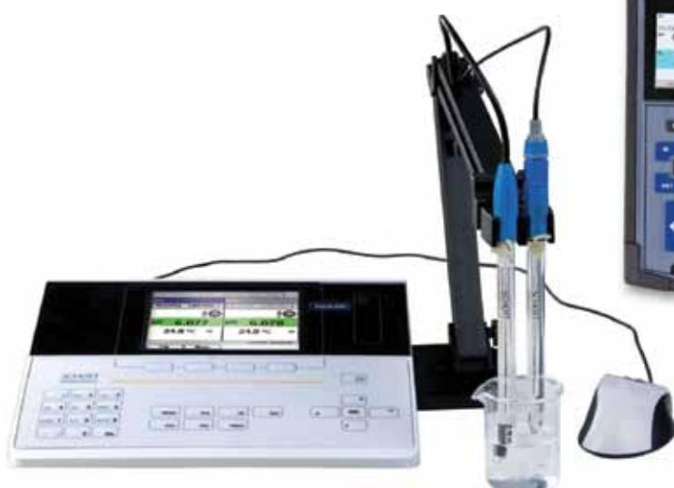
pH metri su elektrohemski aparati koji mere razliku potencijala u rastvoru korišćenjem pH elektrode. Razlika elektrohemskog potencijala u rastvoru je srazmerna koncentraciji H<sup>+</sup> jona. Na osnovu prethodne kalibracije, algoritamski, se razlika potencijala u rastvoru preračunava u pH vrednost ispitivanog rastvora.
