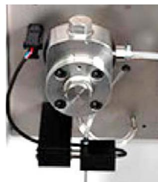
Aparat je opremljen kompletnim novim dvostepenim homogenizatorom visokog pritiska (190 bara), redizajniranim tako da pruži optimum, izdržljivost i dugotrajnost. Temperaturna kontrola homogenizatora održava temperaturu konstantnom. Novi dizajn klipova i opruga klipova homogenizatora omogućavaju viši stepen homogenizacije u odnosu na tradicionalne homogenizatore. Opruge klipova ne dolaze u kontakt sa mlekom, što im znatno produžava vek.
