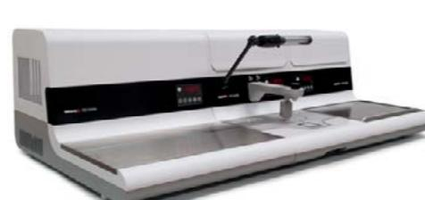
**Kalupljenje** se radi na TES 99 ili na modernijem TES VALIDA. Oba sistema su modularna, sa po 3 dela istih visina koji se mogu koristiti kao kompletan sistem ili zasebno. Zasebni tasteri za paljenje i gašenje na termalnoj i krio konzoli omogućavaju finu kontrolu nad procesom kalupljenja. Na dispenzatorima se nalaze konkicije za grejani forceps a takođe sadrže i pedal za aktivaciju i lampu koja se može podešiti u željeni položaj.
