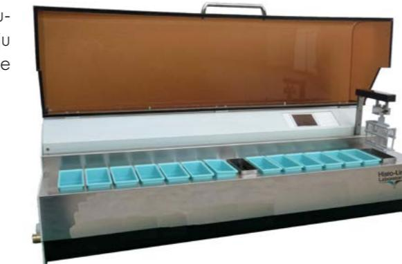
**ATS200 i ATS2010** su napredni modeli automatskih stejnara otvorenog tipa, dizajniranih za veći broj uzorka, sa posebnim naglaskom na zaštitu korisnika i velikom mogućnošću programiranja različitih protokola bojenja. Oba aparata poseduju ekran osjetljiv na dodir, uz pomoć kojeg se na jednostavan i intuitivan način kontroliše proces rada. Snaga ovih aparata je neosporna, i jedina razlika koja ih razdvaja je u njihovom kapacitetu.
