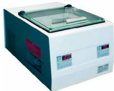
**Dekalcifikacija** se radi sa hemikalijama i ultrazvučnim aparatom USE33 koji ultrazvukom razbija kristalne strukture kalcijum fosfata, magnezijum fosfata i kalcijum karbonata. Difuzija fiksativa, dekalcifikacionog medijuma i intermedijuma su značajno ubrzani.
