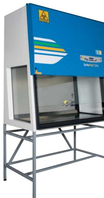
SafeFAST Elite Mikrobiološki sigurnosni kabineti su dizajnirani i izgrađeni tako da zadovoljavaju zahteve EN 12469 : 2000 Evropskog standarda, sa 70% vazduha koji recirkuliše preko glavnog Class H14 HEPA filtera u kabinetu, preostalih 30% se prazni kroz izduvni Class H14 HEPA filter u okolinu.
