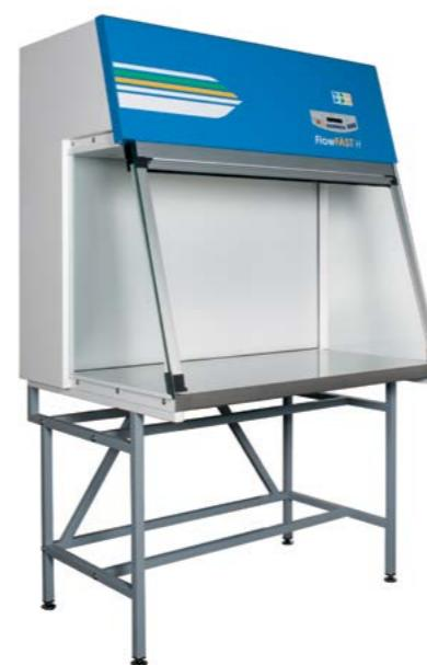
FlowFAST H su horizontalne laminarne komore koje garantuju izvanrednu zaštitu produkta, obezbeđujući čistu radnu zonu (Class 3 prema ISO 14644-1) pomoću G3 predfiltera i HEPA filtera čija efikasnost prevaziđa 99,995% MPPS (Most Penetrating Particle Size – veličina najprodornije čestice) (H14 iz EN 1822)
