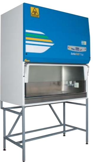
Komora napravljena od čelika, iz jednog komada, omogućava jednostavno čišćenje, čime je obezbeđena najveća stopa perivosti - SafeFAST Top Mikrobiološki sigurnosni kabineti su dizajnirani i izgrađeni tako da zadovoljavaju zahteve EN 12469 : 2000 Evropskog standarda, sa 70% vazduha koji recirkuliše preko glavnog Class H14 HEPA filtera u kabinetu, dok preostalih 30% se prazni kroz izduvni Class H14 HEPA filter.
