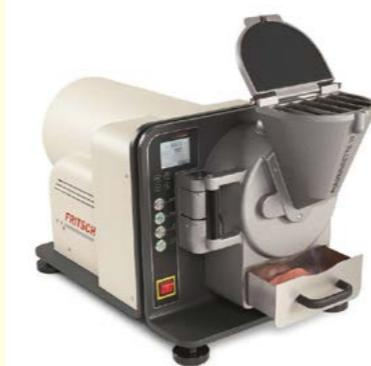
**ANALYSETTE 3 PRO** daju sve što je potrebno za brzo određivanje distribucije čestica različite veličine u laboratoriji. Tresilice sa elektromagnetskim motorom omogućavaju regulaciju vertikalnih oscilacija naslaganih sita. Idealno rešenje za prosejavanje uzorka do 2 kg sa mernim opsegom čestica od 5 µm do 63mm.
