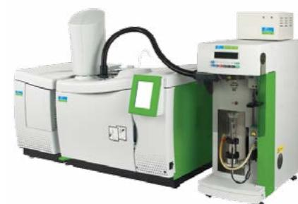
Tehnologija koja spaja dva ili više instrumenta koji zajedno pružaju uvid u hemijske strukture, do sada neviđene drugim tehnikama. Sistem omogućava povezivanje DSC-a, TGA, FT IR-a i GC/MS-a u jedan sistem obezbeđujući sve informacije u vezi jednog materijala.
