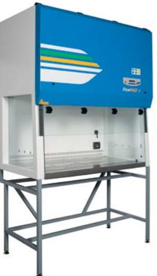
FlowFAST V su vertikalne laminarne komore koje garantuju izvanrednu zaštitu produkta i okoline, obezbeđujući čistu radnu zonu (Class 3 prema ISO 14644-1) pomoću HEPA filtera čija efikasnost prevazilazi 99,995% MPPS (Most Penetrating Particle Size – veličina najprodornije čestice) (H14 iz EN 1822).
