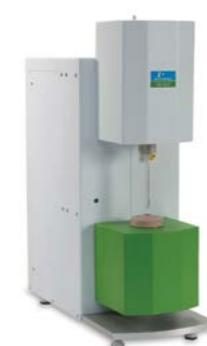
Jedinstveni dizajn koji omogućava termomehaničku analizu za maksimalnu pouzdanost koeficijenta termalne ekspanzije (CTE) u materijalima. Ovaj instrument obezbeđuje da razumete kako se materijal menja sa temperaturom.
