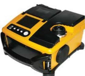
PerkinElmer-ov Torion® T-9 prenosivi gasni hromatograf sa masenim spektrometrom (GC/MS) otvara novo poglavlje gasne hromatografije. Torion tehnologija je integrisala high speed low thermal mass (LTM) i kapilarni gasni hromatograf (GC) sa minijaturnim toroidalnim masenim spektrometrom sa „jonском zamkom”.
