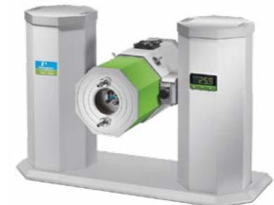
kteristikama kao što su modul, rasipanje energije i materijalna stabilnost pod različitim uslovima uključujući UV, uvećanu vlažnost i u rastvorima. Sada možete analizirati praškaste i druge uzorce kompleksne za pripremu.
