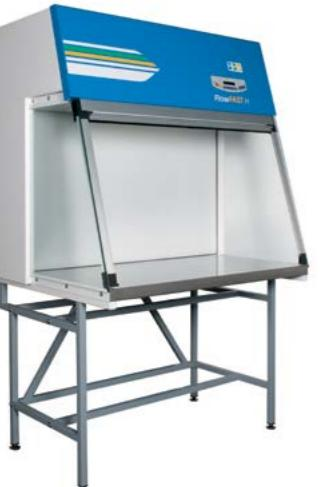
FlowFAST H su horizontalne laminarne komore koje garantuju izvanrednu zaštitu produkta, obezbeđujući čistu radnu zonu (Class 3 prema ISO 14644-1) pomoću G3 predfiltera i HEPA filtera čija efikasnost prevazilazi 99,995% MPPS (Most Penetrating Particle Size – veličina najprodornije čestice) (H14 iz EN 1822).
