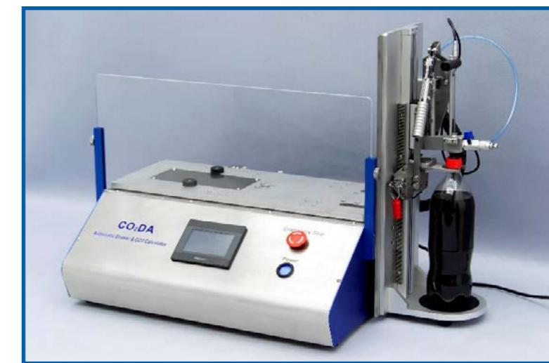
Reč je o specijalnom instrumentu koji služi za određivanje sadržaja CO<sub>2</sub> u bocama pića koja se pune u staklenu ili plastičnu ambalažu i konzerve. Odlikuje se jednostavnim operativnim radom sa visokom reproducibilnošću, pa ga to čini značajnom opremom za kontrolu kvaliteta osvežavajućih napitaka.
