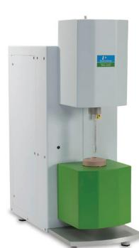
Jedinstveni dizajn koji omogućava termomehaničku analizu za maksimalnu pouzdanost koeficijenta termalne ekspanzije (CTE) u materijalima. Ovaj instrument obezbeđuje da razumete kako se materijal menja sa temperaturom.
