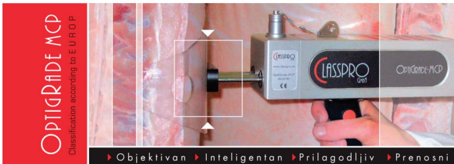
OptiGrade je najnoviji merni instrument sa najmodernijim mogućnostima za klasifikaciju svinjskih polutki. **Ovaj aparat, jednostavnim korišćenjem, omogućava određivanje procenta mesa na polutkama.** Sonda aparata probija polutku, refleksija svetlosti koju daju meso i masti osnovnom kalkulacijom daju procenat mesa.
