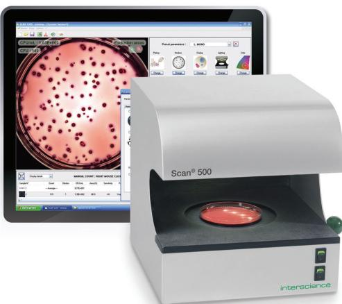
Poseduje digitalnu kameru i moćan softver. Povezivanje sa računarcem preko Firewire konekcije. Minimalna veličina kolonije koja se može detektovati je 0.05mm. Detektuje i broji do 7 boja na jednoj Petri šolji. Mogućnost brojanja na Petri šoljama (50-90mm), spiralnim pločama, hromogenim podlogama, antibiogramima, Petrifilm®RIDA™ COUNT/Sanita-kun™, Compact Dry™, membranama za filtraciju. Automatsko odvajanje zbijenih kolonija.
