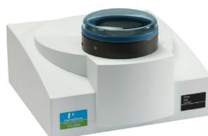
Kompaktan i robustan instrument za termalne analize visokih performansi koristi se za analiziranje kompozicije materijala i kinetičke studije.
