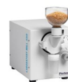
Mlin čekićar se koristi za pripremu uzorka za Broj padanja, Glutomatic sistem i NIR analize.
