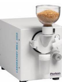
Disk mlin spesificno dizajniran i odobren za mlevenje uzorka u kojima će se određivati vlaga.
