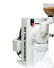
Mlin čekićar. Pogodan je za mlevenje uzorka predviđenih za analizu Falling Number /Broj padanja/, Glutomatik Sistem /određivanje glutena/, Kjeldal /određivanje proteina/i NIR analize.
