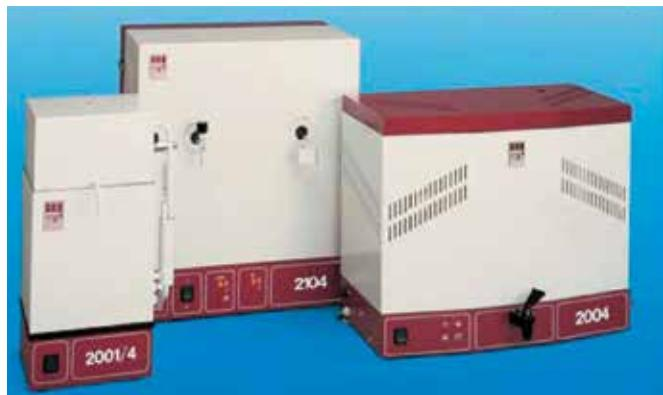
kapacitetima 4 do 12 litara, destilatori manjeg kapaciteta dostupni su sa ili bez rezervoara, destilatori većeg kapaciteta poseduju rezervoar za čuvanje destilovane vode.
