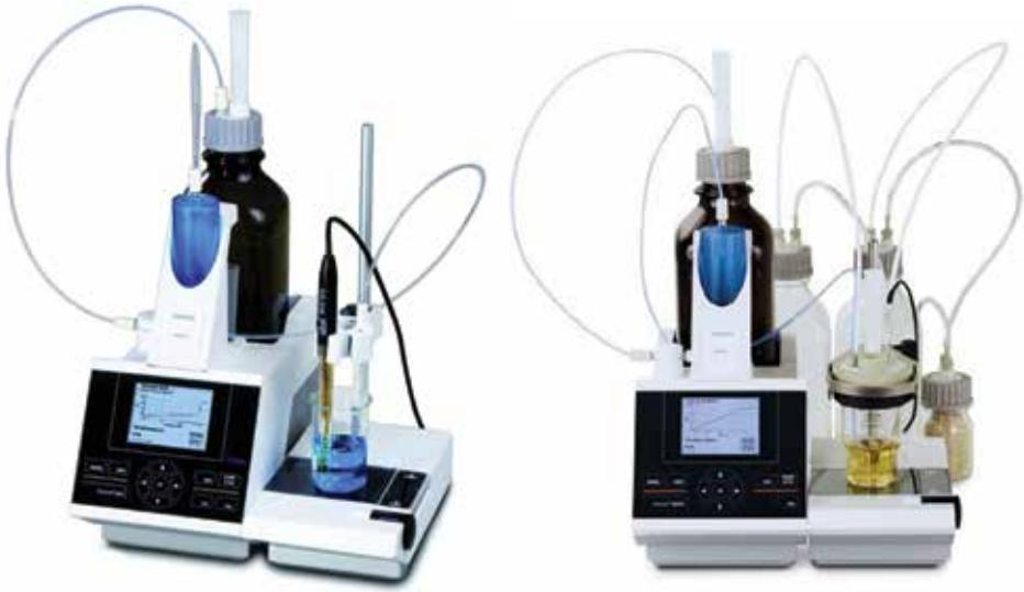
**TitroLine 6000** – Jednostavan titrator vrhunskih performansi za potenciometrijske titracije. Savršen izbor za potenciometrijske titracije. Tipična primena: pH titracije, alkalitet, permanganatni broj, COD, Kjeldhal, FOS/TAC, hloridi, hlor, ukupna tvrdoća, rastvoreni kiseonik.
