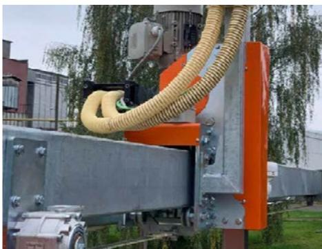
Četvrtasti dupli zidovi uzorkivača sa bočnim nosačem na teleskopskoj ruci za lakše servisiranje
