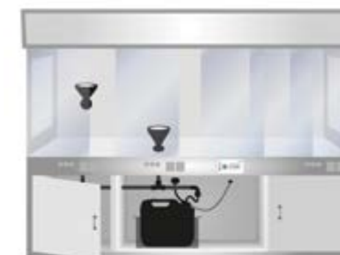
SCAT sistem: Primer izgleda instalacije na digestorima
