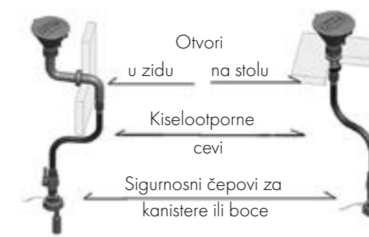
Prikaz montaže SCAT sistema
